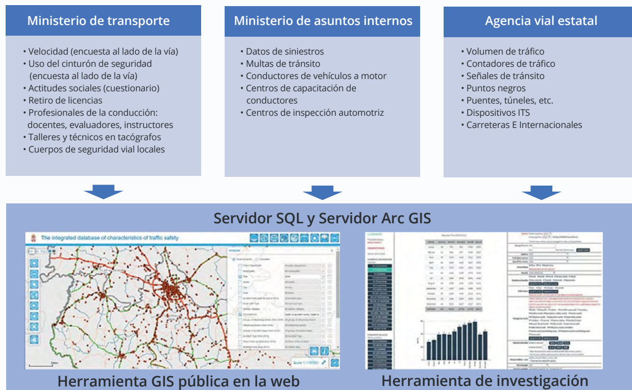
Figura B2.2.1 Diagrama de flujo de la base de datos nacional de seguridad vial de Serbia
